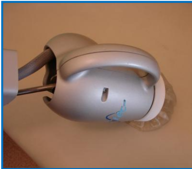
Rys. 6. Przykład aplikatora diatermii mikrofalowej: antena z promiennikiem (źródło: archiwum własne)
