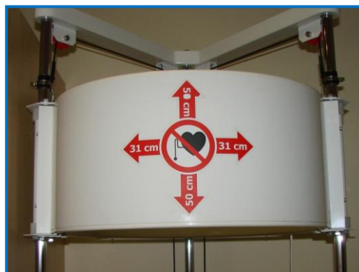
Rys. 19. Znaki ostrzegawcze dla użytkowników implantów medycznych według PN-EN ISO 7010:2012 (a) oraz przykład oznakowania aplikatora urządzenia do magnetoterapii z podaniem zasięgów ograniczonego dostępu dla użytkowników implantów aktywnych (b), (źródło: archiwum własne)
