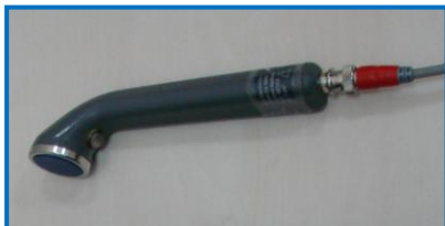
Rys. 9. Przykładowy aplikator zabiegowy urządzenia do terapii ultradźwiękowej (źródło: archiwum własne )
